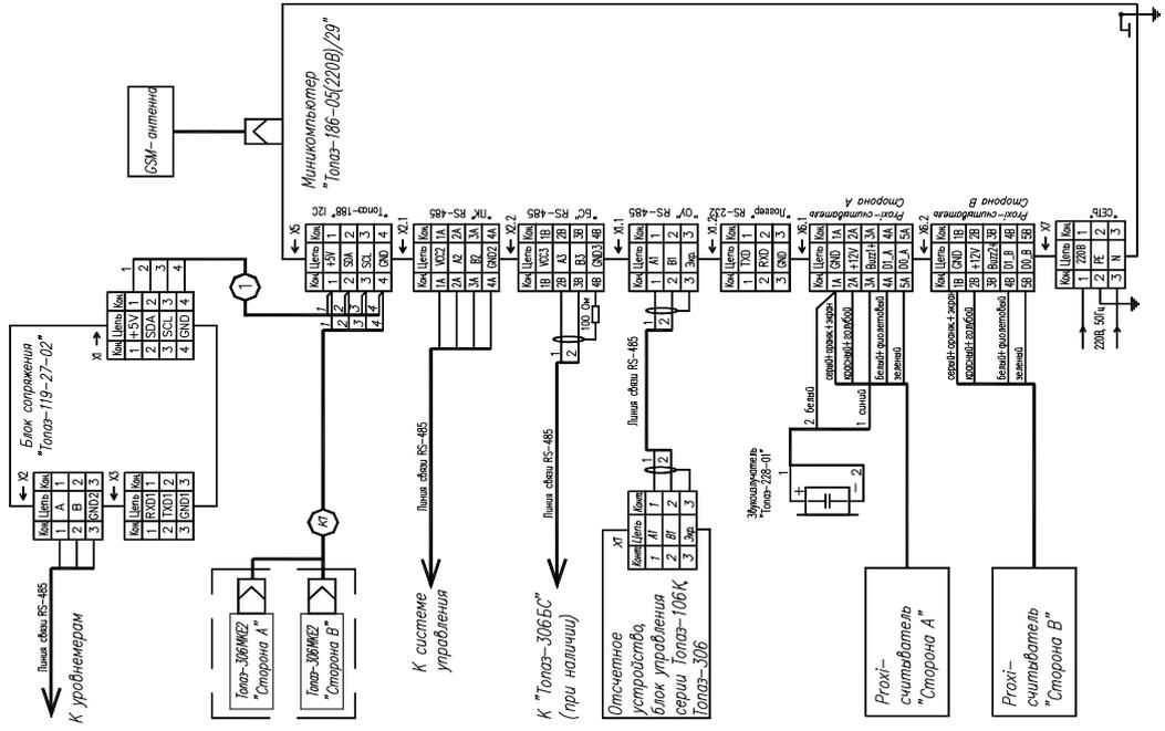
Рис. 4.1 Схема электрическая подключения миникомпьютера "Топаз-186-05".
