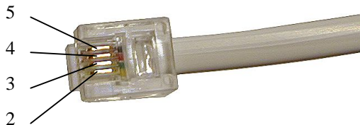
Нумерация контактов вилки 6Р4С (контакты 1 и 6 отсутствуют)
